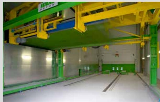
Die Ein- und Auslagerung der Elemente im Hochregallager erfolgt vollautomatisch.
