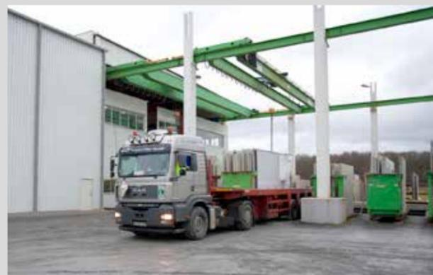
Per LKW werden die Fertigteile im sogenannten Innenlader stehend zur jeweiligen Baustelle transportiert.
